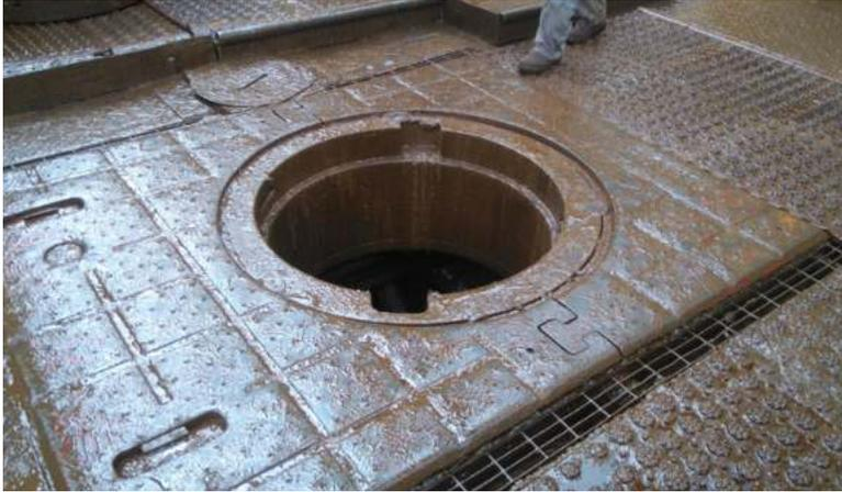
fácil instalación y anclaje en cualquier mesa rotaria.
