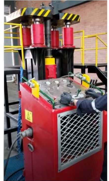
El test de tensión se realiza utilizando la HPUE, la cual trasmite potencia hidráulica a los pistones del banco de pruebas y al HCRT.
